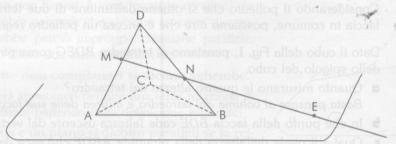
La retta MN appartiene al piano ABD (piano  $\alpha$ ) poiché due dei suoi punti appartengono a questo piano. Il punto E, allora, è un punto del piano  $\alpha$  e, poiché deve appartenere anche al piano della faccia ABC (piano  $\beta$ ), sarà un punto della retta AB, intersezione fra  $\alpha$  e  $\beta$ .
